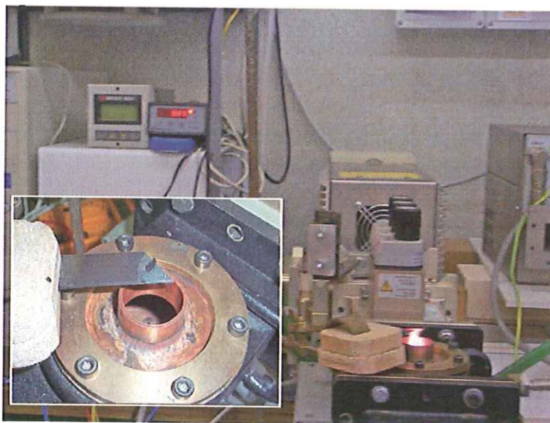
La figura seguente mostra il campione durante la lavorazione e, nel riquadro, una vista da vicino del campione dopo 5 secondi di esposizione del plasma.
